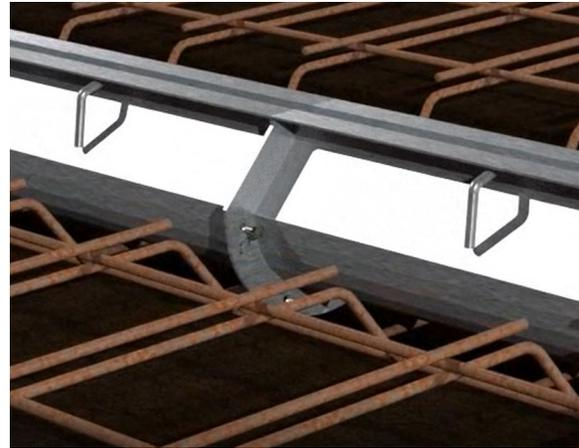
6. Fixez les supports de montage à chaque intervalle de support de soutien, à l'aide du matériel fourni. Enfoncez des longueurs appropriées de barres d'armature dans votre matériau de base, les barres d'armature passant à travers le support de montage. Assurez-vous que tous les dessus de section sont de niveau. Lorsque les niveaux corrects sont atteints, serrez les boulons de réglage sur les supports de montage pour fixer le caniveau.
